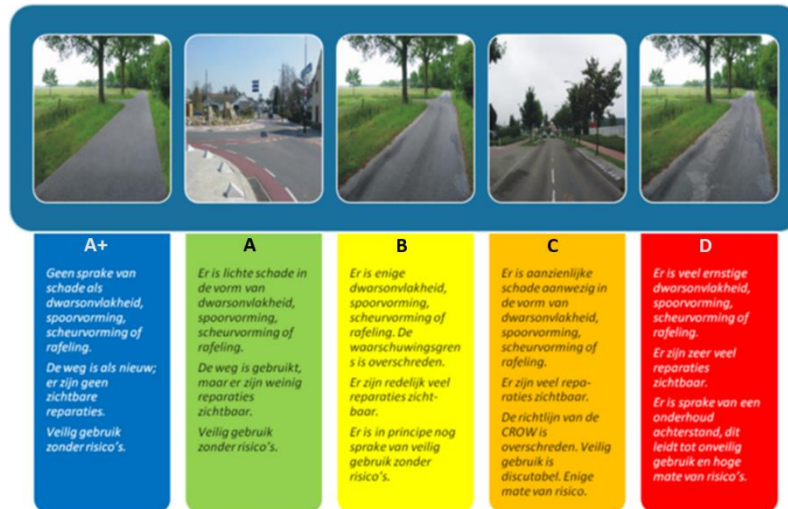
Figuur 3.4 Meetlat asfaltverharding
