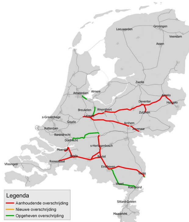
Figuur 4: vergelijking overschrijdingen PR-10 8 -risicoplafonds in 2020 t.o.v. 2019
