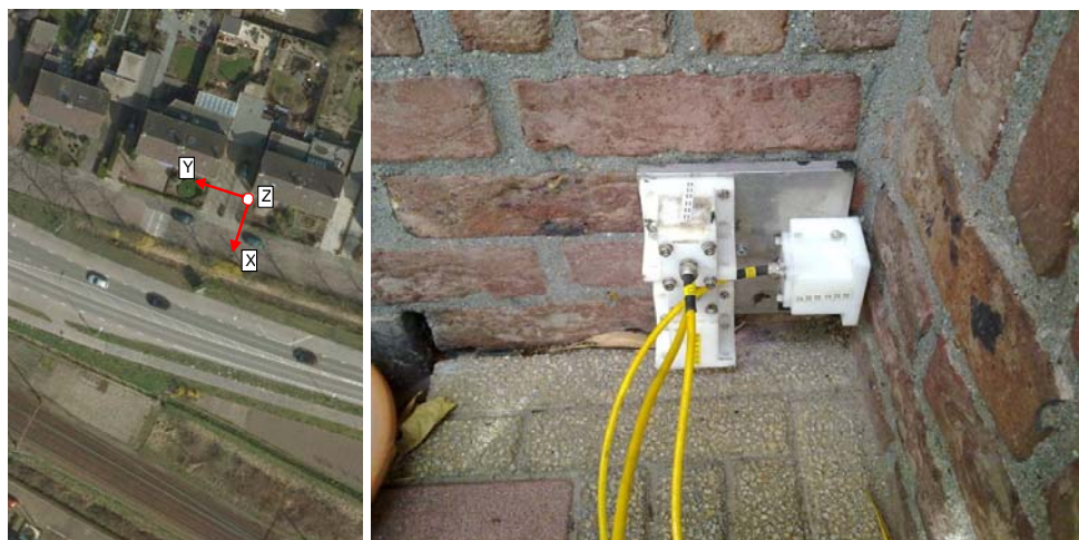
Figuur 5: Referentieband aan de Koningin Wilhelminastraat 5. Links: positie en richting versnellingsopnemers. Rechts: Versnellingsopnemers ter plekke van de fundering..
