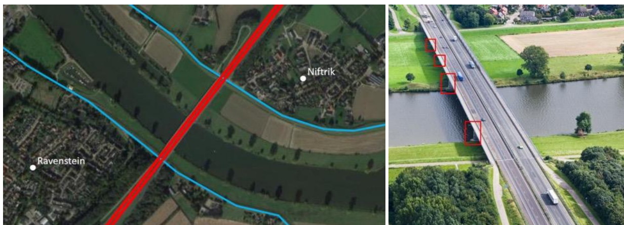
Afbeelding 10.3.1: Situatieschets Maasbrug (links); In rood huidige ligging A50, in blauw primaire waterkering. Luchtfoto Maasbrug (rechts) met brugpijlers in rood kader aangegeven (bron: Beeldbank RWS).
